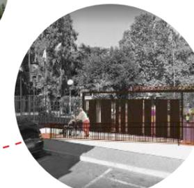
**INGRESSO DA VIA CASELLE:** previsto intervento di abbattimento barriere architettoniche attraverso la demolizione dei gradini esistenti e la realizzazione di una rampa a norma (pendenza non superiore all'8%) incassata al posto dei gradini. Il marciapiede, rialzato di 15 cm rispetto alla strada, è accessibile senza barriere dall'attraversamento pedonale prospiciente l'asilo Simone Stella.
