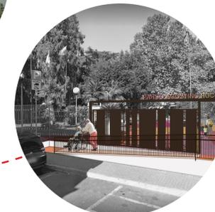
**INGRESSO DA VIA CASELLE:** previsto intervento di abbattimento barriere architettoniche attraverso la demolizione dei gradini esistenti e la realizzazione di una rampa a norma (pendenza non superiore all'8%) incassata al posto dei gradini. Il marciapiede, rialzato di 15 cm rispetto alla strada, è accessibile senza barriere dall'attraversamento pedonale prospiciente l'asilo Simone Stella.
